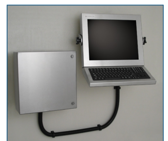
Poste de travail et écran pour client léger à montage mural.
